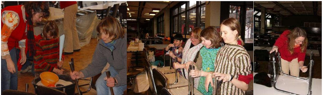
verdichtet, die Einfüllöffnungen verschlossen u. der Stuhl einer Endkontrolle unterzogen.
