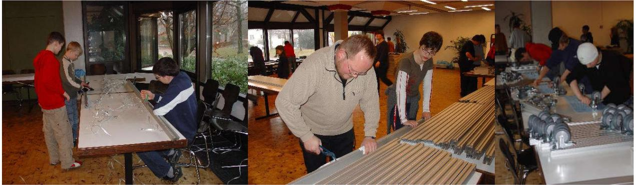
Nicht benötigte Profileile werden entfernt. Rollenelemente werden verschraubt.
